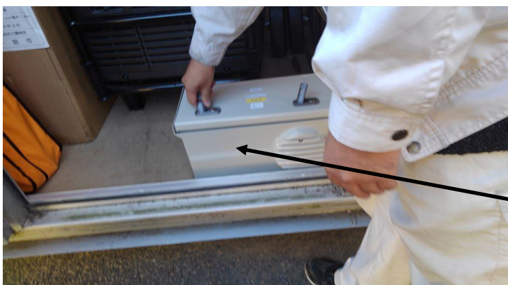
防災倉庫内に保管されている防災Wi-Fi
